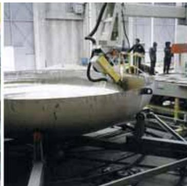
Schleifen von Durchmessern bis 11000mm
